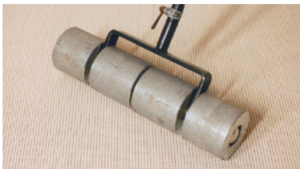
Vältning med tung vält (70 kg) är nödvändigt för att erhålla ett bra resultat
